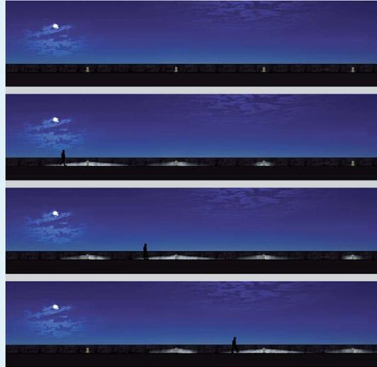
Pour créer des vagues de lumière, il faut détecter la présence d'utilisateurs et déterminer leurs caractéristiques précises: nature (piéton, cycliste, voiture, etc.), position, vitesse, etc. Ces résultats sont obtenus en utilisant des programmes informatiques complexes.
