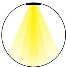
**Flexible Lichtverteilungen:** Dank rotationssymmetrischer Linsen-Optiken stehen verschiedene Ausstrahlwinkel von 15° (Spot) über 30° / 50° (Flood / Medium Flood) bis 85° (Wideflood) zur Verfügung. So lässt sich sowohl punktuelle Akzentbeleuchtung als auch gleichmäßige Allgemeinbeleuchtung realisieren.
