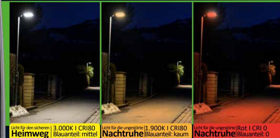
Licht für den sicheren Heimweg | 3.000K | CRI80 | Blauanteil: mittel | Licht für die ungestörte Nachtruhe | 1.900K | CRI80 | Blauanteil: kaum | Licht für die ungestörte Nachtruhe | Rot | CRI 0 | Blauanteil: 0
